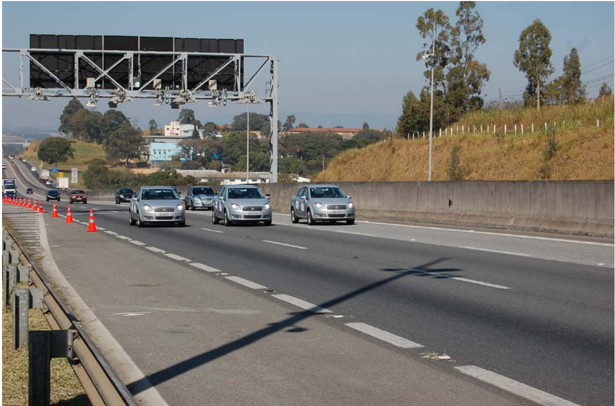
VEÍCULOS PORTANDO TRANSPONDERS DO TIPO SINIIV EM VÁRIOS TIPOS DE COMBINAÇÃO DE PASSAGEM PELO SISTEMA DO PORTAL SENDO PROCESSADOS AUTOMATICAMENTE PELO PORTAL DESENVOLVIDO PELO CENTRO VON BRAUN
